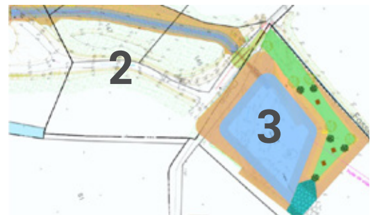
Bassin tampon pour les écoulements liquides
